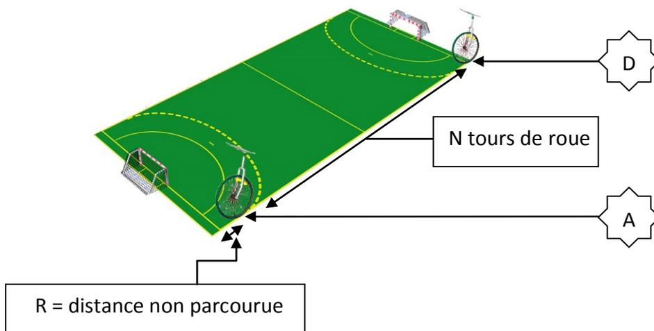
On part de la position D jusqu'à la position A. On s'arrête en A (c'est ainsi que ce point est déterminé) parce que si l'on effectuait un  $N+1^{i\text{ème}}$  tour de roue, on sortirait du terrain.
