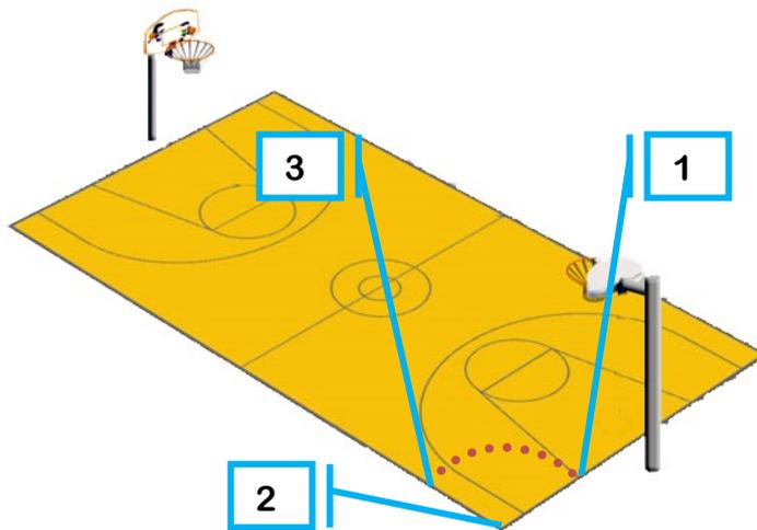
Tendre une première ficelle non extensible du point 1 au point 2. Par pivotement d'un quart de tour autour du point 1, amener le début de la ficelle sur la longueur du terrain pour marquer 3. Les points 1, 2, 3 sur le terrain sont les sommets d'un demi-carré. Construire avec une seconde ficelle l'équerre isocèle voulue. Noter que le terrain permet de mettre aux moins 6 équipes de 4 enfants au travail simultanément. Ces mêmes équipes pourront employer leur production lors de la visite au Louvre.
