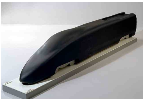
18 Forme de motrice de TGV MX-100 utilisée pour les essais en soufflerie, 1997. Modèle au 1/15. Inv. 43540
