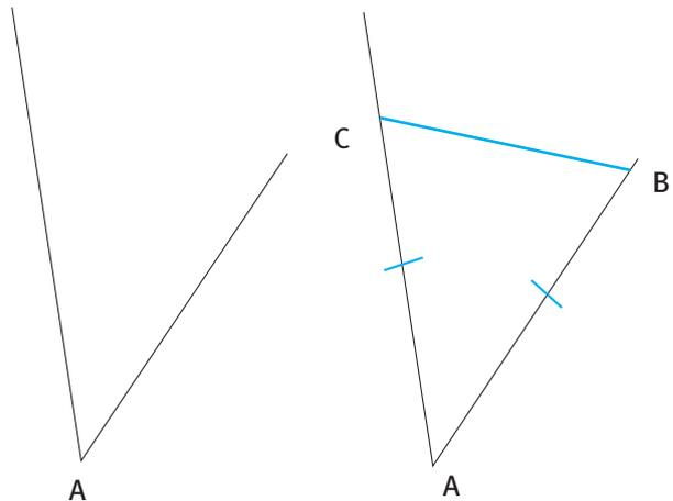
2. Appeler A le sommet de l'angle à reproduire. Placer un point B sur un côté de l'angle, tracer la perpendiculaire en B à ce côté, elle coupe l'autre côté en un point C, le triangle ABC est rectangle en B, il suffit alors de mesurer [AB] et [BC] et de se rappeler la construction d'un triangle rectangle (voir exercice 3).
