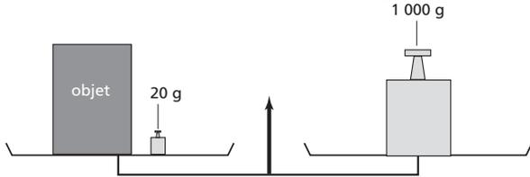
Lors de la mise en commun, attirer l'attention des élèves sur le fait que les deux plateaux peuvent être utilisés indifféremment pourvu que les conditions d'équilibre soient respectées. Par exemple, l'objet et la masse de 20 g peuvent être aussi bien sur le plateau de gauche que sur le plateau de droite.
