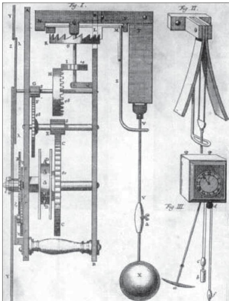
Le pendule et « l'échappement » de Huyghens (extrait de *Horlogium Oscillatorium*, 1673)
