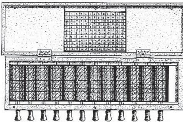
Des bâtonnets de Neper montés dans un coffre de bois. À l'intérieur du couvercle, une table d'addition.
