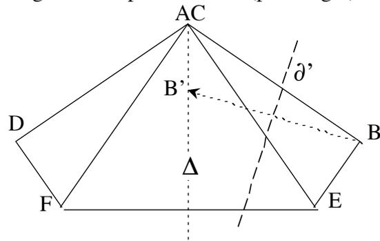
Le pli est [EF]. Plier ensuite [BE] sur la diagonale  $\Delta$ ; le pli  $\partial'$  est indiqué en traits interrompus. Replier de même [DF] sur la même diagonale. On obtient un pentagone qui est *presque* régulier.
