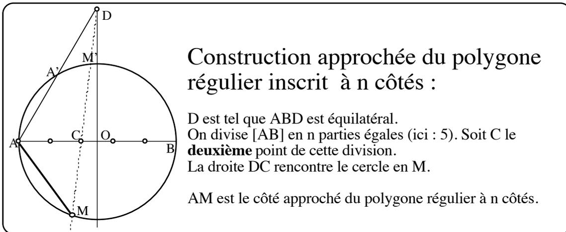
On se propose d'examiner la qualité de l'approximation. La résolution du triangle DAC permet de calculer l'angle DAC :
